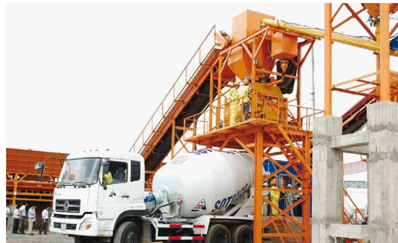
Trạm trộn bê tông RCC
